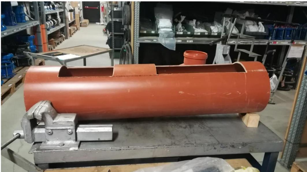
La prova consiste nel posizionare sulla finestra piccola la derivazione a sella PVC De 160 mm e fissare tale braga, non potendo in sede di prova utilizzare altri materiali leganti attrezzature, con delle fascette da elettricista unite insieme.
