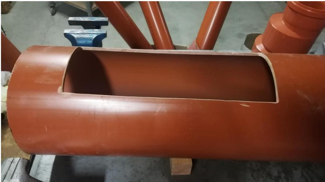
La prova consiste nel posizionare a copertura della finestra grande uno dei tronchetti tubo fogna PVC De 250 mm bianco con il taglio rivolto verso la parte bassa del tubo e fissare tale fascia, non potendo in sede di prova utilizzare altri materiali leganti attrezzature, con delle fascette da elettricista unite insieme.
